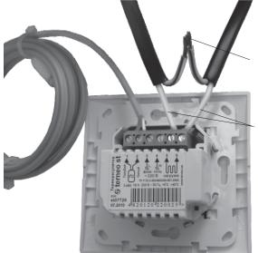
Желто-зеленый провод (экран) соединить между собой и подключить к земле (при отсутствии земли — к нулю).
